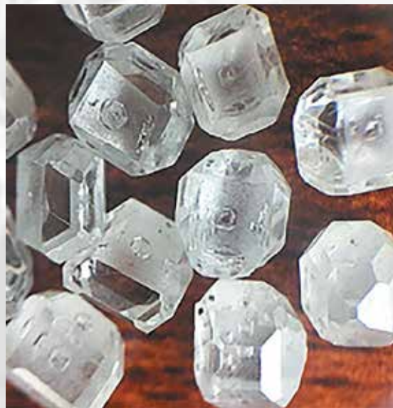
Рисунок 1. Монокристаллы НРНТ-алмаза. На фотографии на кристаллах хорошо видны затравки, производство: Китай, 2018 г.
