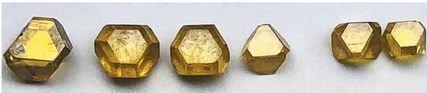
Рисунок 3. Октаэдрическая форма НРНТ монокристалла
