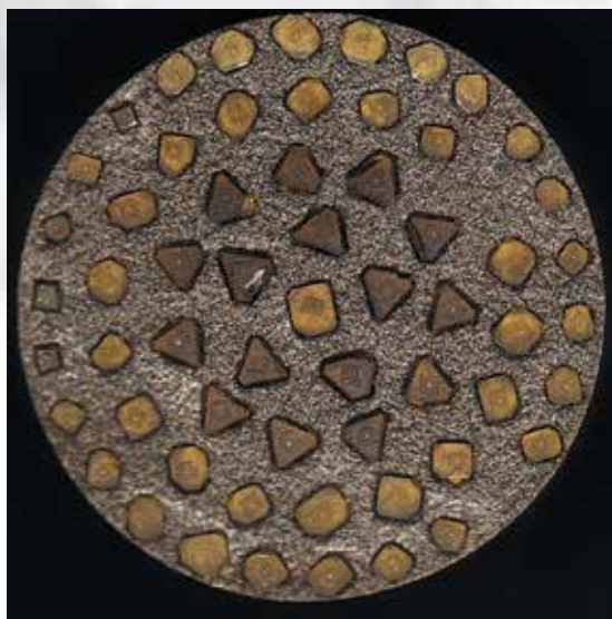
Рисунок 2. Ячейка высокого давления после синтеза с кристаллами октаэдрической формы
